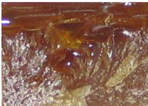
图 6 改性脂环胺固化剂 WZH-155 固化 CYD-128 环氧树脂
