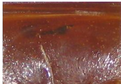
图 7 乙二胺固化 CYD-128 环氧树脂试样冲击后的断面形貌
